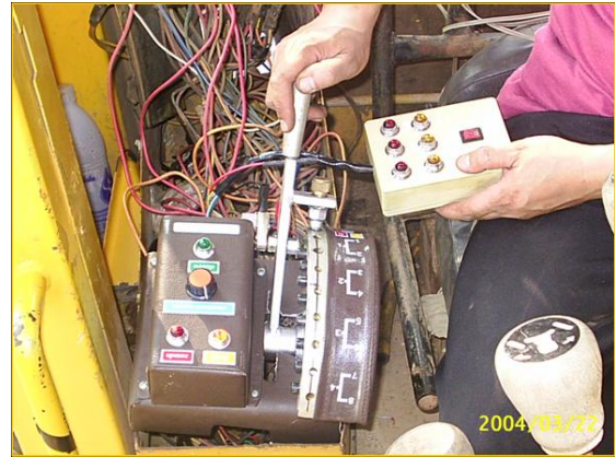
การทดสอบการทำงานอุปกรณ์ควบคุม การเปลี่ยนเกียร์ (แบบใหม่)
