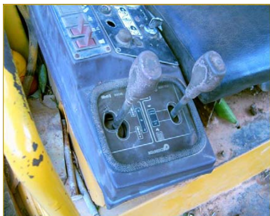
การติดตั้งอุปกรณ์ควบคุมการเปลี่ยนเกียร์ (แบบเดิม)
