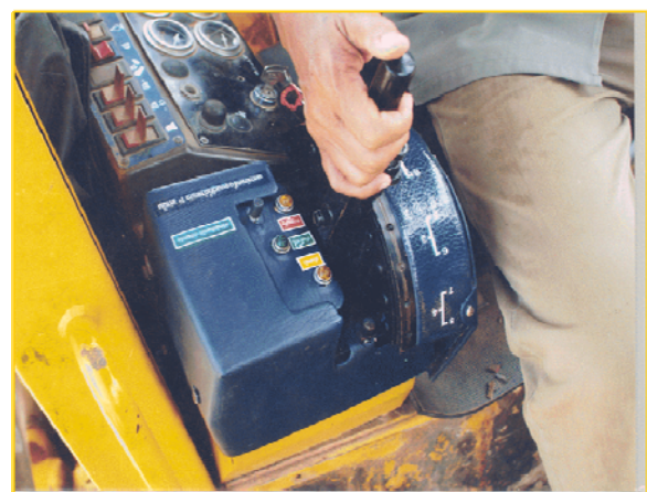
การติดตั้งอุปกรณ์ควบคุมการเปลี่ยนเกียร์ (แบบใหม่)
