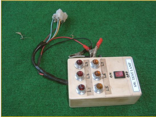
เครื่องมือทดสอบการทำงานอุปกรณ์ควบคุม การเปลี่ยนเกียร์ (แบบใหม่)
